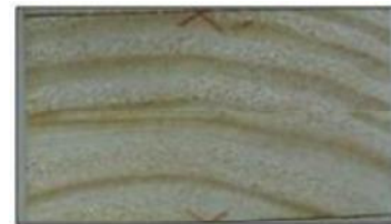
Figura 5: Combinación de planos de corte tangencial externo-tangencial interno.
