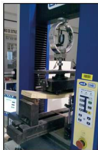
Figura 1. Ensayo de flexión estática de plano. Figure 1. Plane static bending test.
